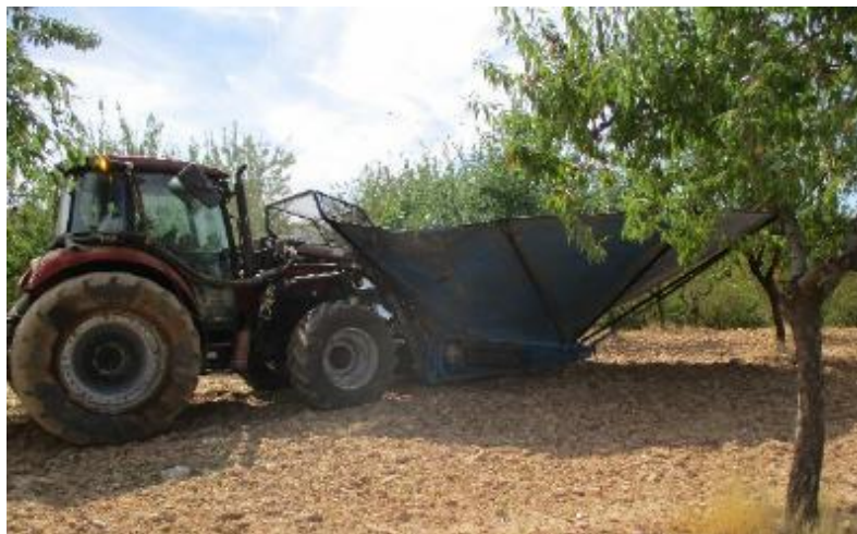
Figura 44. Colheita mecanizada com chapéu “apara-frutos”, 17.09.2026, Castelo Branco - Mogadouro Foto por: Miguel Martins
